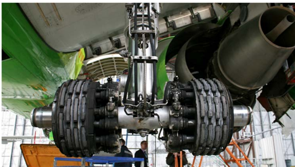
Рис. 4. Магниевые тормозные диски шасси самолета
