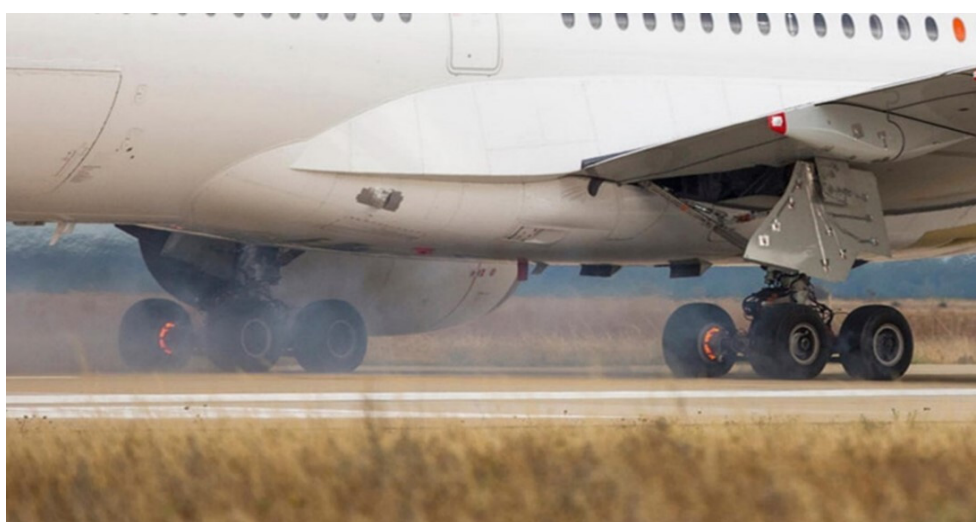
Рис. 5. Раскаленные тормоза самолета после экстренного торможения
