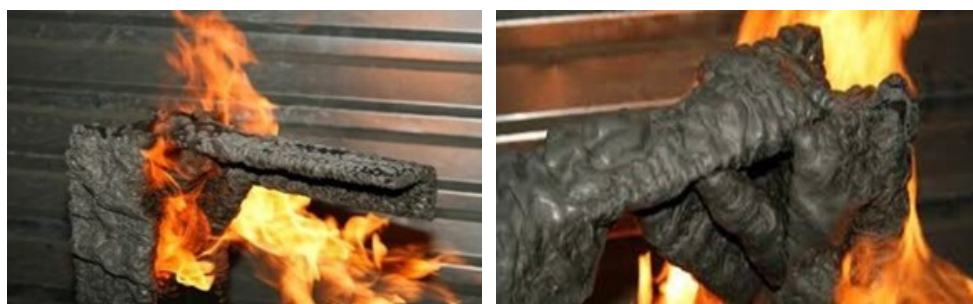
Рис. 6. Образование слоя спекшейся корочки на поверхности металлического изделия при тушении порошковым составом
