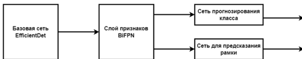
Рис. 1. Архитектура сверточной нейронной сети EfficientDet
