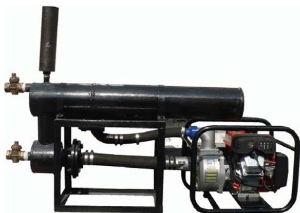
Рис. 1. Автономный вихревой термогенератор
