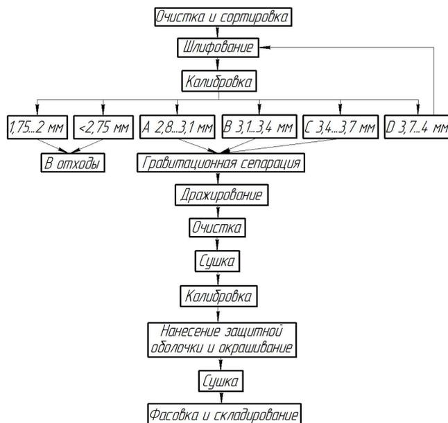
Рис. 1. Технологическая схема производства дражированных семян
