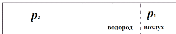
Рис. 1. Схематичное изображение ударной трубы с различными газами в камерах высокого и низкого давления
