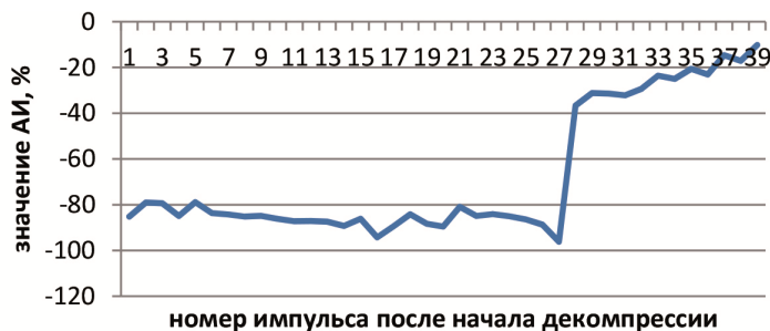
Рис. 4. Изменение значения АИ в процессе декомпрессии гидроманжеты при осциллометрическом измерении АД
