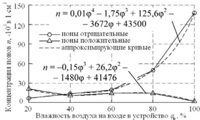
Рис. 4. Зависимости концентрации ионов от относительной влажности воздуха на входе
