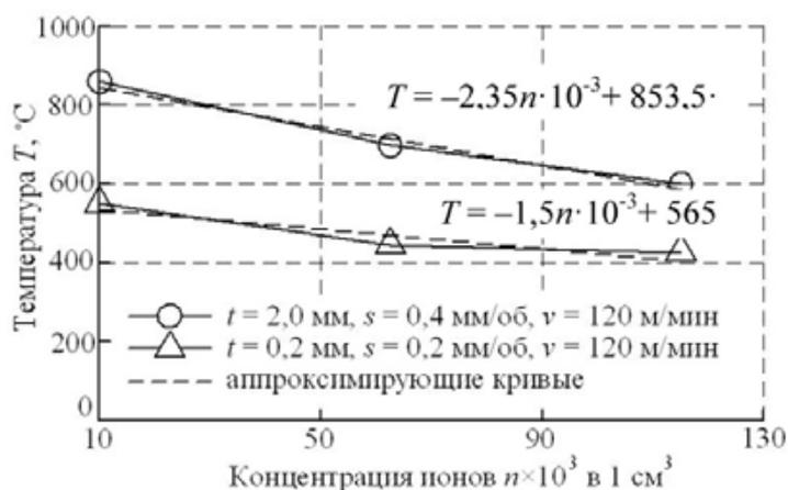
Рис. 5. Зависимости температуры в зоне резания от концентрации ионов
