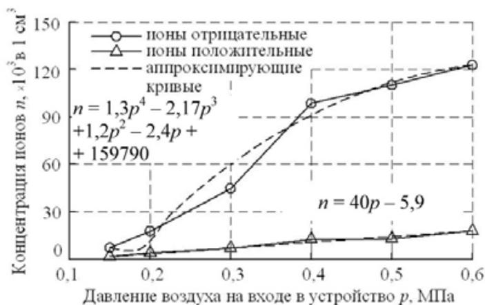
Рис. 3. Зависимости концентрации ионов от давления воздуха на входе (при увлажнении воздуха до 100 %)
