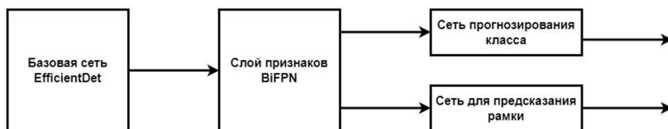
Рис. 1. Архитектура сверточной нейронной сети EfficientDet
