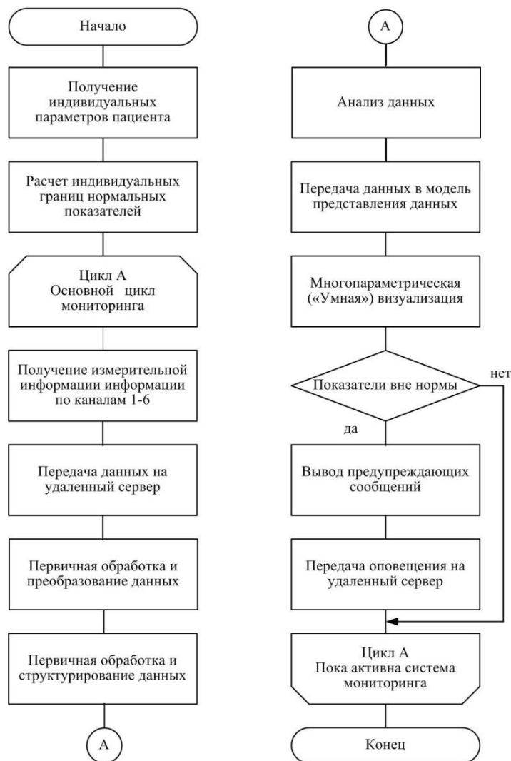
Рис. 3. Алгоритм работы приложения мониторинга
