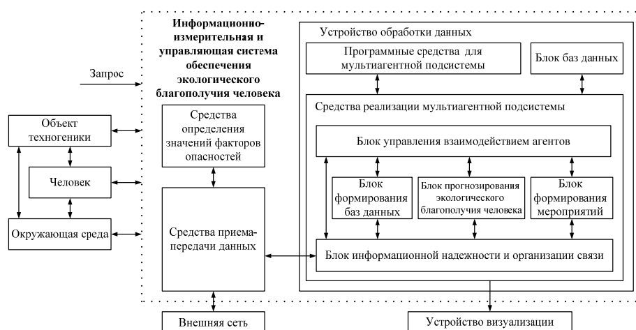
Рис. 1. Упрощенная схема информационно-измерительной и управляющей системы обеспечения экологического благополучия человека [21]
