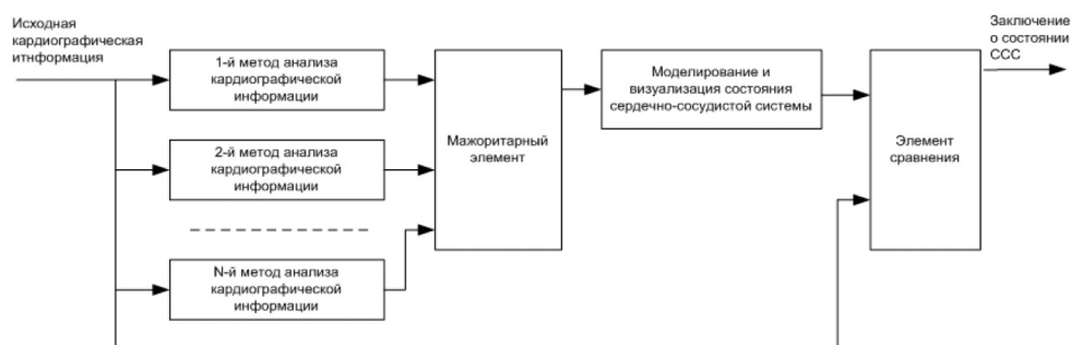
Рис. 2. Схема обработки кардиографической информации
